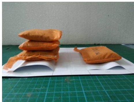
ภาพที่ 8 การทดลองวางถุงทรายลงบนกระต่ายโค้ง
